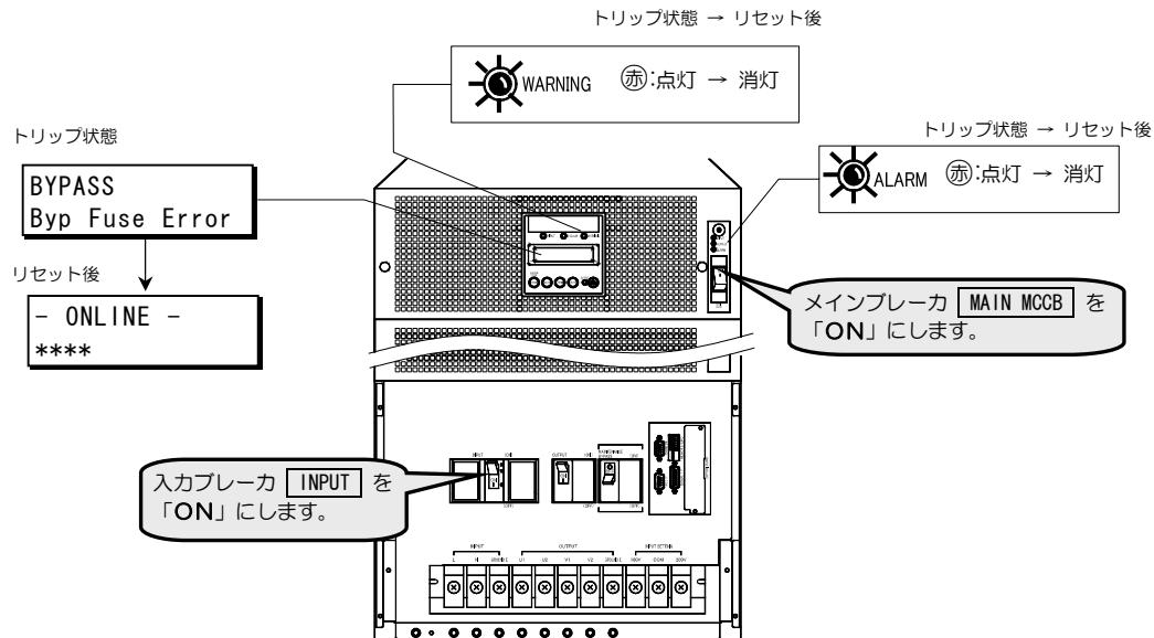
図はAタイプ集電ユニットの場合を示します。
