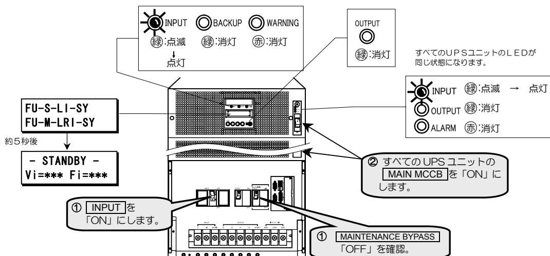
図はAタイプ集電ユニットの場合を示します。
