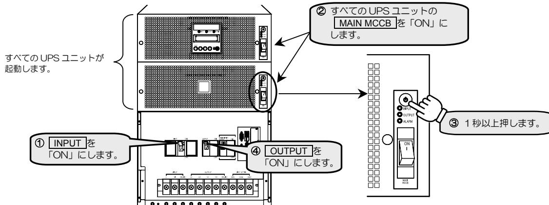
図はAタイプ集電ユニットの場合を示します。
