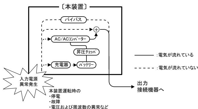
バッテリー運転時の電気の流れ
