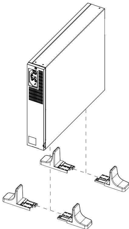
増設バッテリーボックスがある場合は、下図のように、ペデスタルを連結して本体に取付けて下さい。また、連結金具を使ってUPS本体と増設バッテリーボックスをネジで固定してください。増設バッテリーボックスが2台以上ある場合は、同様に連結金具をネジで固定して下さい。ネジはUPS本体、および、増設バッテリーボックスに取り付けられているので、該当箇所のネジを一旦、はずしてから固定作業を実施してください。
